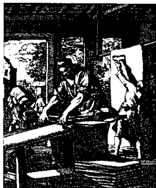
De droogscheerder, uit: Jan en Kasper Luiken, Spiegel van het menselyk bedryf (Amsterdam, 1767). Op de voorgrond scheert de droogscheerder met zijn scharen een laken, rechts op de achtergrond wordt een laken met een kaart geruwd.
